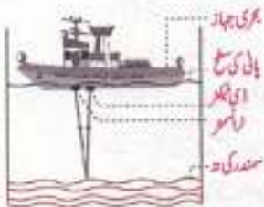
شکل 11.14: سمندر میں پانی کی گہرائی کی پیمائش الٹراسونک ویوز کے ذریعے ایک خاص طریقہ استعمال کرتے ہوئے کی جاتی ہے
