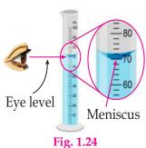
Fig. 1.24 Measuring Cylinder
